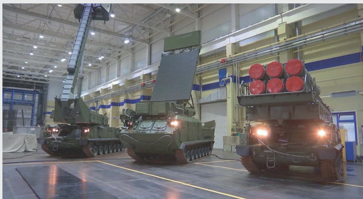
Ключевые элементы ЗРК «Бук-М3» — радар низковысотного подсвета и наведения 9С36М, РЛС обнаружения 9С18М3 и самоходная огневая установка 9А317М с высокоманевренными ЗУР средней дальности 9М317М
