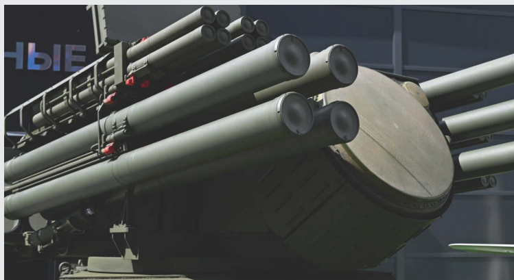
Боевой модуль ЗРПК «Панцирь-СМД-Е» с боекомплектом из штатных ЗУР 57Э6 и малогабаритных ЗУР 19Я6.
